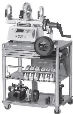
Аппарат в полной комплектации для бесшовной сварки систем трубопроводов SYGEF Standard, SYGEF Plus, PROGEF Plus, PROGEF Natural размерами d20-63 мм, оснащен съемным сварочным блоком, 2 USB входами, монохромным дисплеем с отображением знаков на 12 языках.
